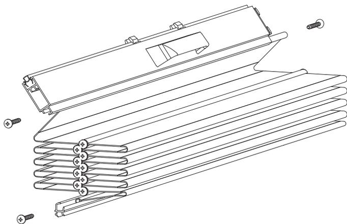
Coloca otro poste de mando en lugar del fijador si desea abrir la puerta de ambos lados
