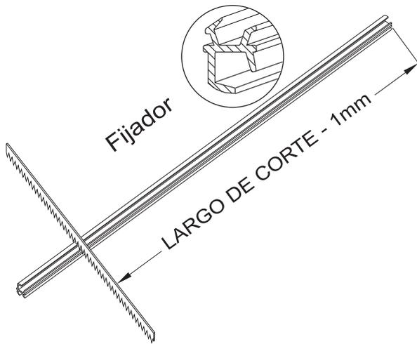
El fijador no se usa cuando se arma una puerta que abre de ambos lados
