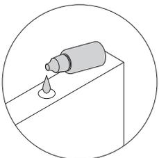
Coloca pegamento (6 gotas por barreno) a todos los barrenos donde vas a insertar **96**
