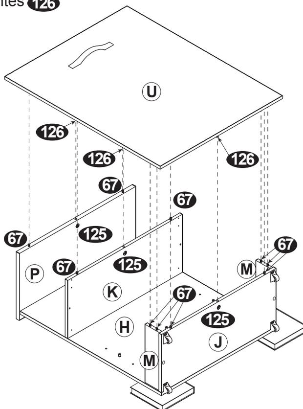
Coloca pegamento (4 gotas por barreno) al barreno donde vas a insertar (67)
