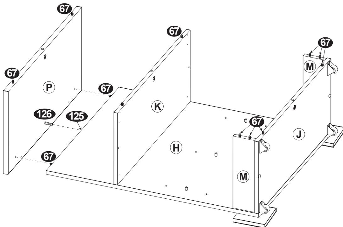
Coloca pegamento (4 gotas por barreno) al barreno donde vas a insertar (67)
