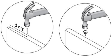
Para clavar la pieza **72** hacer una guía con un clavo alfilerillo a 3 cm de la orilla y después poner **72** en la guía y clavarlo.
