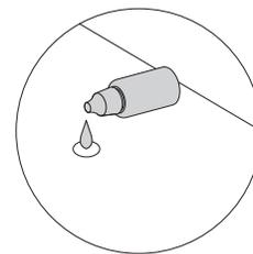
Coloca pegamento (4 gotas por barreno) al barreno donde vas a insertar (67)
