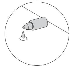
Coloca pegamento (4 gotas por barreno) al barreno donde vas a insertar **67**
