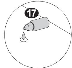
a) Coloca pegamento (5 gotas por barreno) a todos los barrenos donde vas a insertar 1
