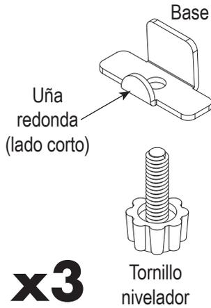
B) Coloca la base de manera inclinada apoyando la uña redonda (lado corto) a la mampara y empuja, asegúrate que la perforación de la base coincida con la perforación de la mampara
