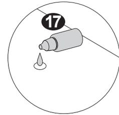
Coloca pegamento (5 gotas por barreno) a todos los barrenos donde vas a insertar **1**
