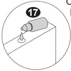
Coloca pegamento (2 gotas por barreno) a todos los barrenos donde vas a insertar **67**
