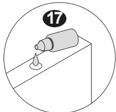
Coloca pegamento (8 gotas por barreno) a todos los barrenos donde vas a insertar **1**
