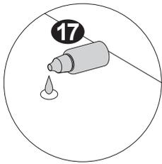
Coloca pegamento (4 gotas por barreno) a todos los barrenos donde vas a insertar **67**
