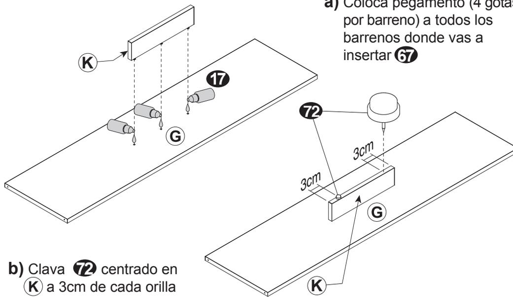
a) Coloca pegamento (4 gotas por barreno) a todos los barrenos donde vas a insertar **(67)**
