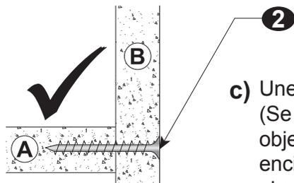
c) Une el piso **B** del cajón. (Se recomienda colocar objetos pesados o libros encima del piso durante el secado del pegamento, aproximadamente 15 minutos)
