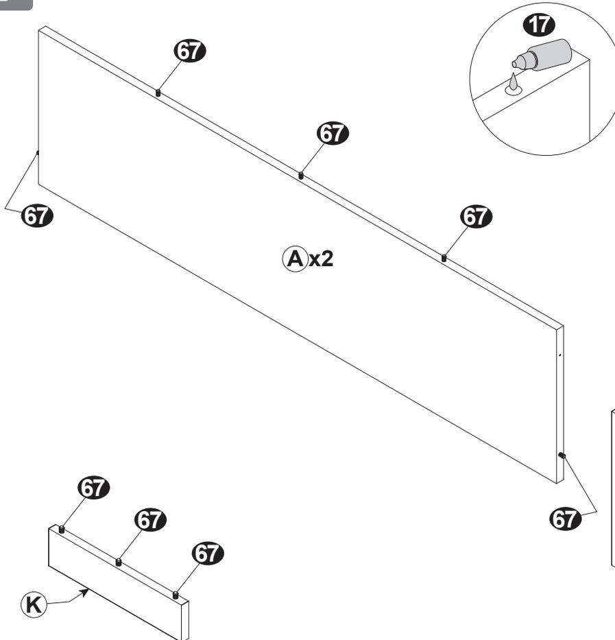
Coloca pegamento (8 gotas en cada barreno) a todos los barrenos donde vas a insertar 67
