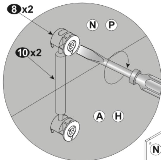
d) Ensambla **N**, **O** y **P** con **A**, **B** y **H**, después gira **8** a la derecha para apretar
