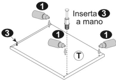
a) Coloca gotas de pegamento en las perforaciones de la tapa donde vas a insertar **2**
