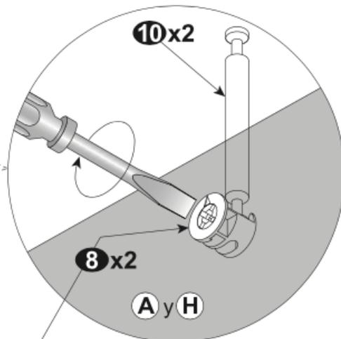
Inserta **8** con la flecha señalando hacia arriba, introduce **10** en **A** y **H** después aprieta
